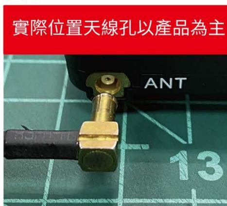
本公司GPS產品皆有預留ANT外接天線孔。天線安裝、拔除時,請保持水平裝卸,以免造成天線頭損壞。
