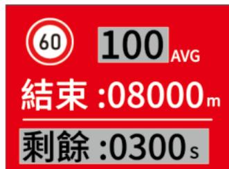
若行駛均速(從區間測速路段開始到目前醒使位置的平均時速)高於路段速限後，會以紅色底色提醒使用者，此時就須降低車速
